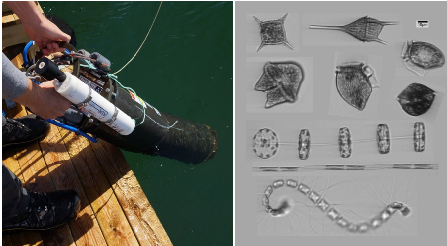
Fig. 45. Imaging FlowCytobot (IFCB) är ett automatiskt mikroskop som kan användas under vatten, på land eller på fartyg. AI används för analys av de tusentals eller miljontals bilder som samlas in. Till vänster: IFCB vid en musselodling i Tångesund vid Orust. Till höger: exempel på bilder av växtplankton från IFCB i Tångesund.
